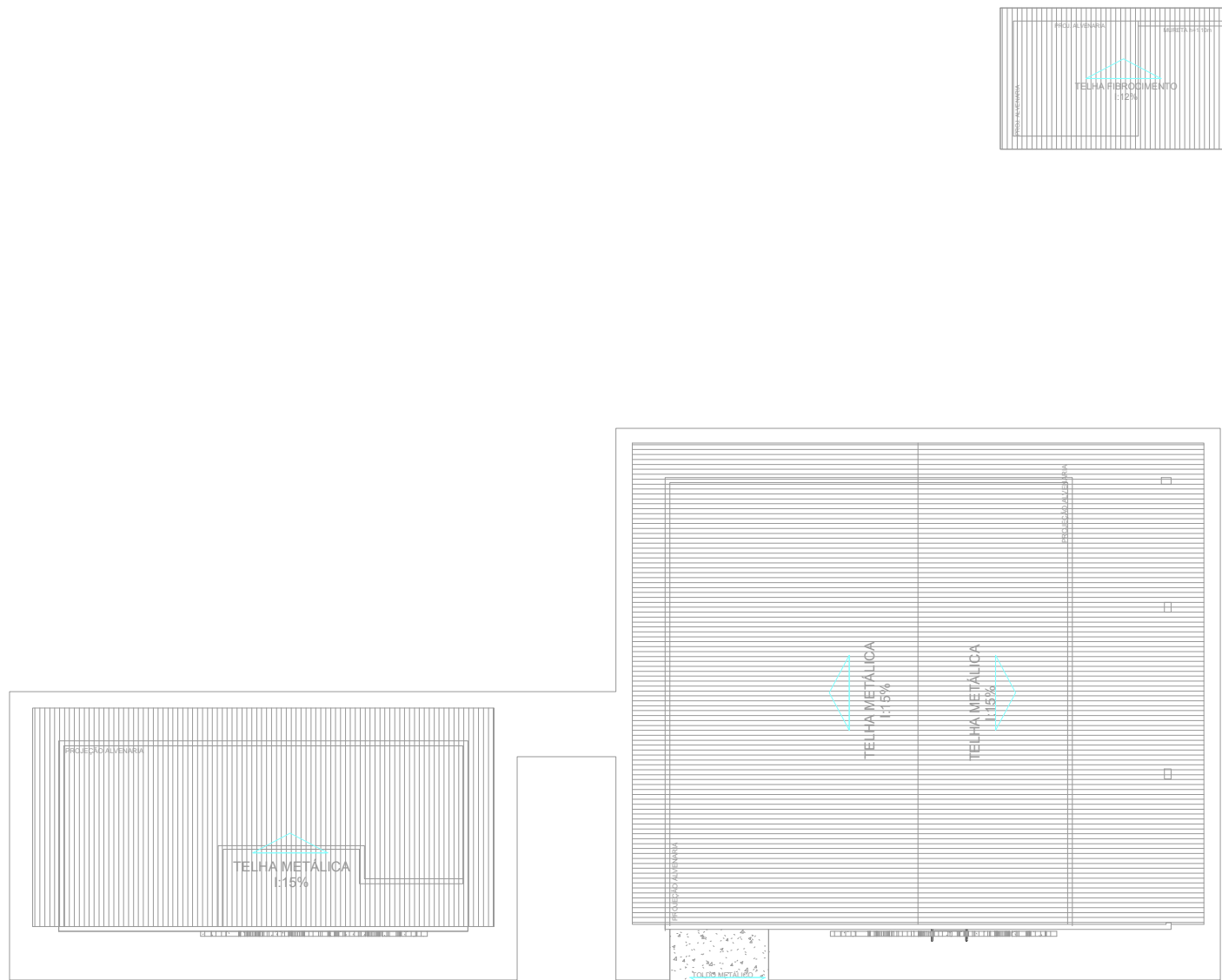
4 PLANTA DE COBERTURA - Administração, Indústria e Caldeira ESCALA: 1:200
