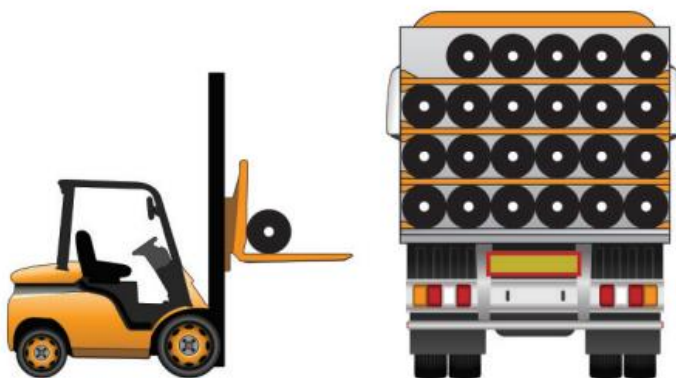
FIGURA 5 – EXEMPLO DE CARREGAMENTO DAS BOBINAS DE MEMBRANA PEAD. FONTE: NEOPLASTIC, 2016.
