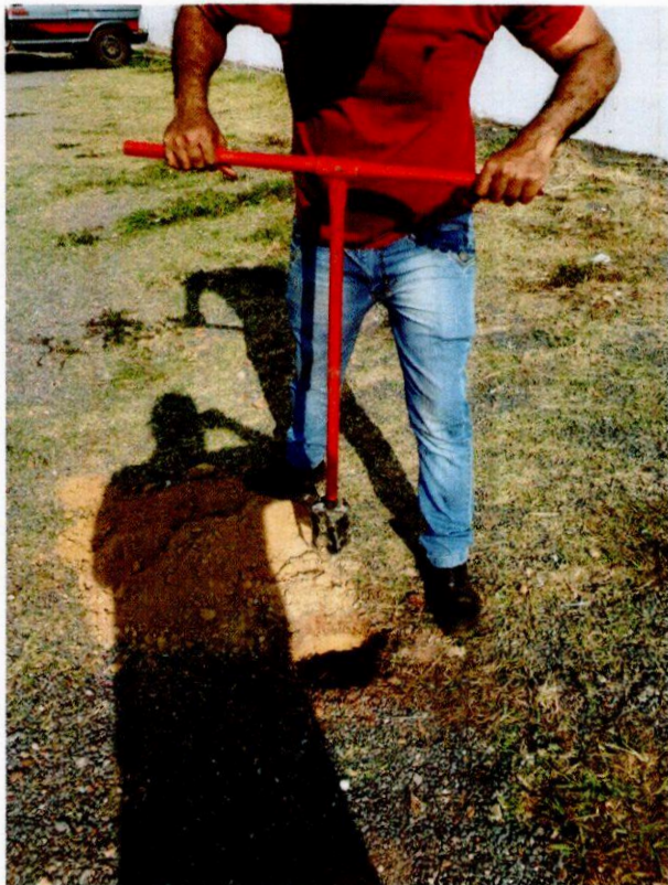
Execução de sondagem com PDL (Penetrômetro Dinâmico Leve)
